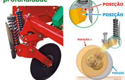
Disco de corte com regulagem de profundidade
